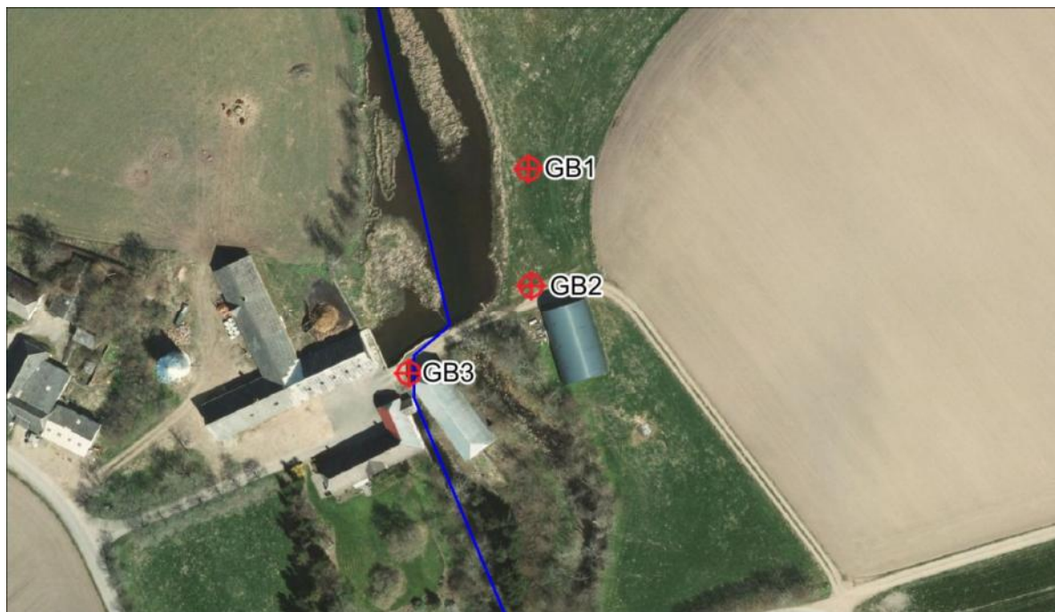
Figur 10 Placering af geotekniske borer ved Gundestrup Mølle.
